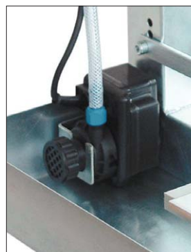
Pumpe – Versorgung der Bohrkronen mit Kühlwasser
